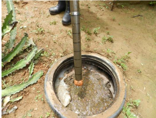
Medición de lodos
